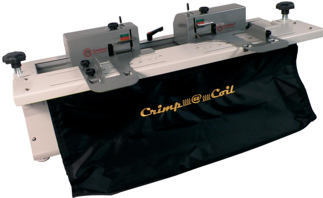
La Crimp@Coil es una máquina eléctrica de construcción robusta para el corte y doblado del espiral plástico en todos sus diámetros (de 8 a 50 mm) con un mismo cabezal. No requiere el uso de herramientas para los cambios de tamaño.
